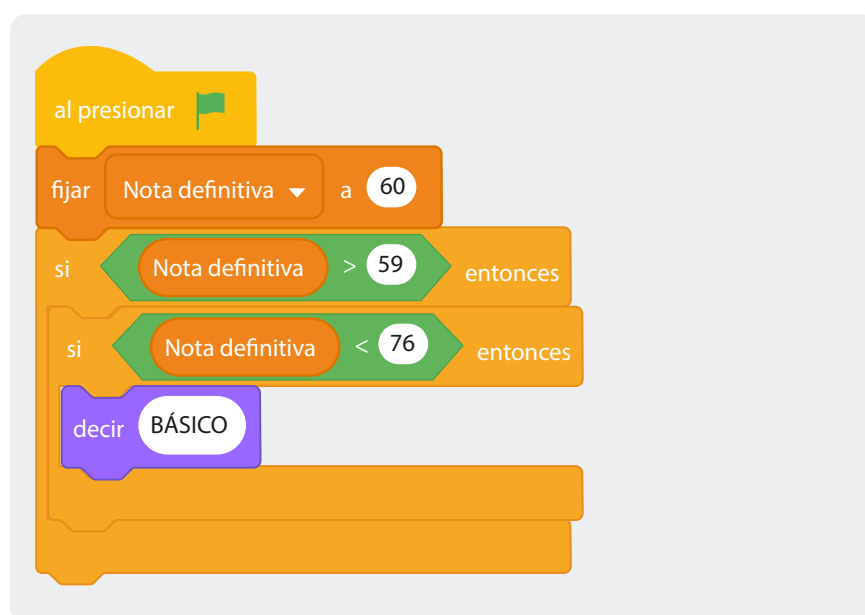
Figura 3. Condicional anidada para clasificar la nota en Scratch
